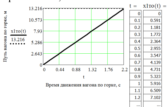
Рис. 2. Графическая зависимость пройденного расстояния при движении вагона на длине 1ТП горки после затормаживания от времени
